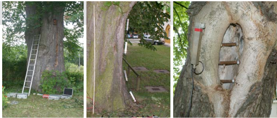
Abb. 2: Begleitende Zugversuche mittels Inclino/Elastomethode.
